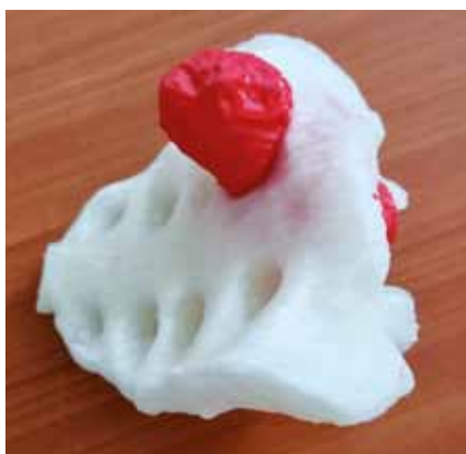
5 Model kosti křížové se schwannomem pravostranného kořene S1 vpravo v červené barvě. Příklad tisku ze dvou materiálů tiskárnou se dvěma tiskovými hlavami. Semitrparentním materiálem je vytištěna kost a červeným pak tumor, který se šíří mimo páteřní kanál.
